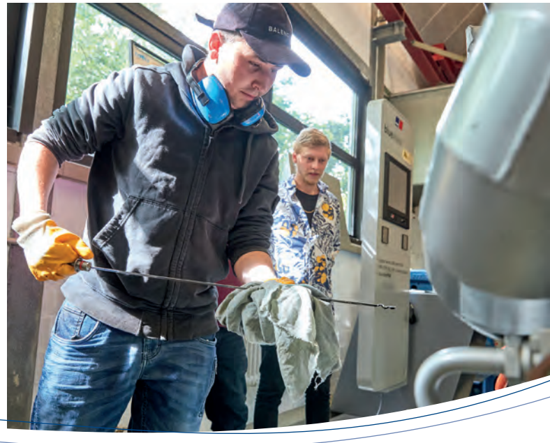
Prüfung der Öl-Qualität und -Quantität am Peilstab
